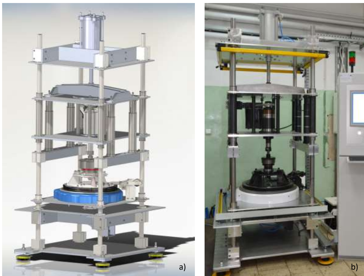
Rys. 2. Nowe stanowisko do pomiaru momentu oporowego łożysk tocznych. a) model wirtualny, b) prototyp wdrażany w Fabryce Łożysk Toczących w Kraśniku.
