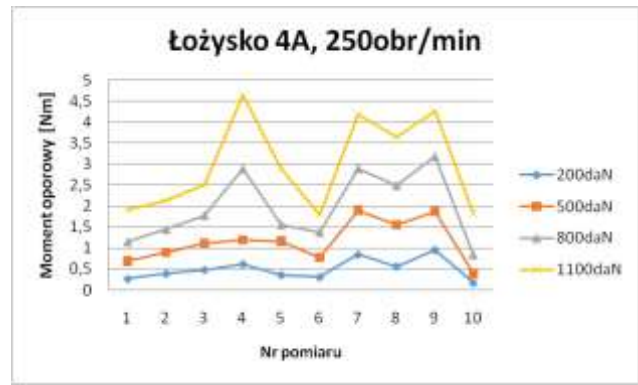
Rys.13. a) seria pomiarów łożyska nr 3A, b) seria pomiarów łożyska nr 4A
