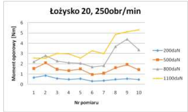
Rys.12. a) seria pomiarów łożyska nr 10, b) seria pomiarów łożyska nr 20.
