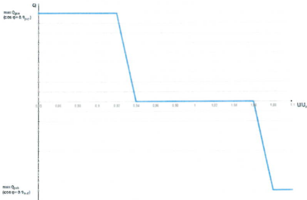
Rys. 3. Charakterystyka sterowania mocą bierną w funkcji napięcia wymagana przez OSD.
